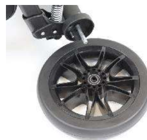
Zdj. 9.5.2 Demontaż koła
