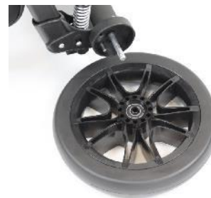
Zdj. 9.5.2 Demontaż koła
