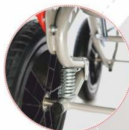
AMORTYZACJA KÓŁ TYLNYCH
