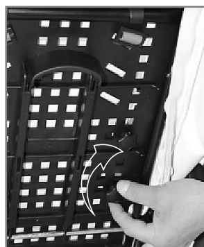
Zdj. 10.2.3. Wykręcenie śrub
