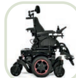
technologia napędu na środkowe koła
