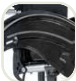
osłona boczna z włókna węglowego
